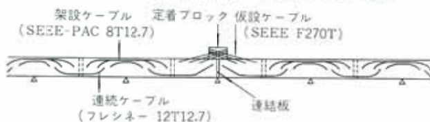
図-12 架違い部の施工
